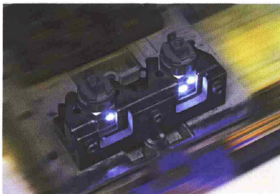
Sistema di timbratura laser per l'identificazione dei prodotti Euroswitch .
